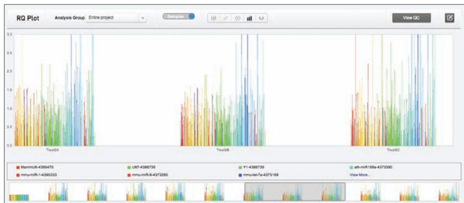
図5. 「Relative quantification」モジュールでは、比較したいデータをグループ化し、その増幅曲線から相関関係や散布図を表示することができます。
