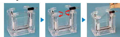
① カバーを外します ② ノブを回します ③ バッファーを捨てずにゲルを取り出します
