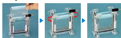
① ゲルを差し込みます ② ノブを回します ③ ゲルのセット完了!
