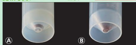
① 帯電防止型30mLチューブ 種子の飛散がない。 ② 市販P.P.製チューブ 種子が飛散する。
